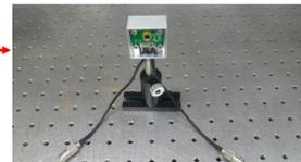
Fig. 8 : detector (photodiode)
