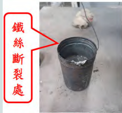
高溫鋁液杯型模具左側固定用鐵絲斷裂脫落
