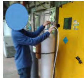
事故：移動鋼瓶時，未裝妥護蓋，致瓶內 氣體噴出，使人員受傷
